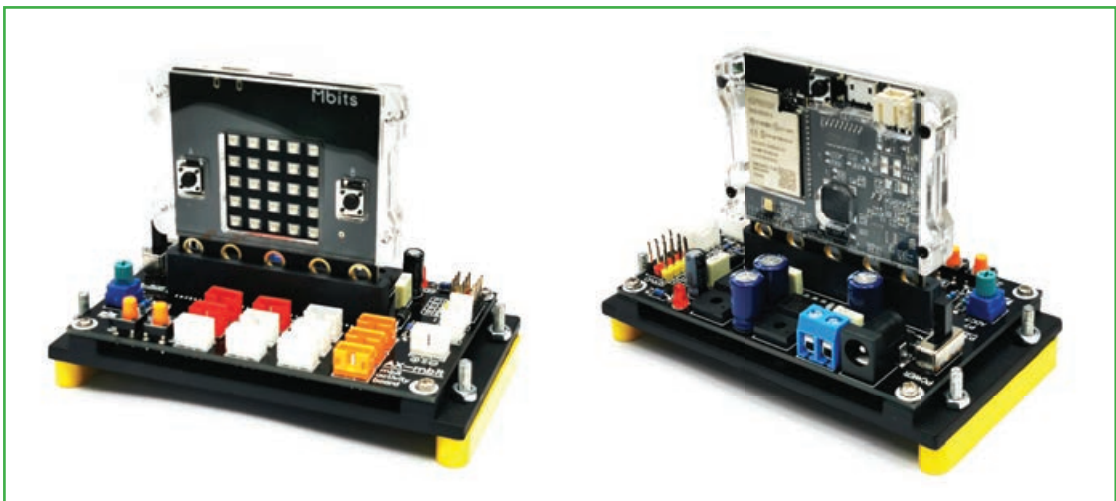
รูปที่ 6-3 การต่อใช้งานของบอร์ด Mbits V2 กับบอร์ด AX-Mbits
