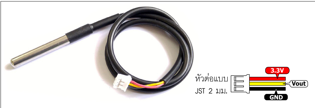
รูปที่ 6 หน้าตาของ ZX-MCP9701 ไอซีวัดอุณหภูมิที่มาในรูปแบบของหัววัดโลหะพร้อมใช้งาน
